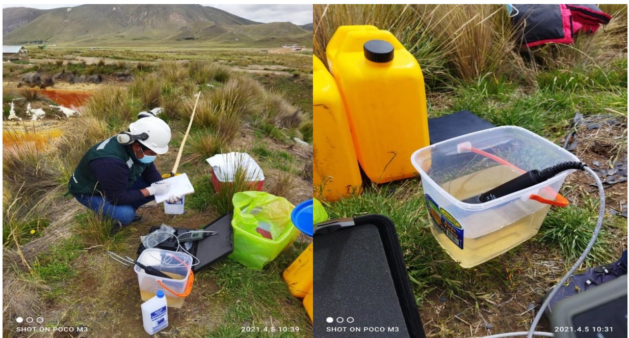
Figura 28. Medición de parámetros in situ
